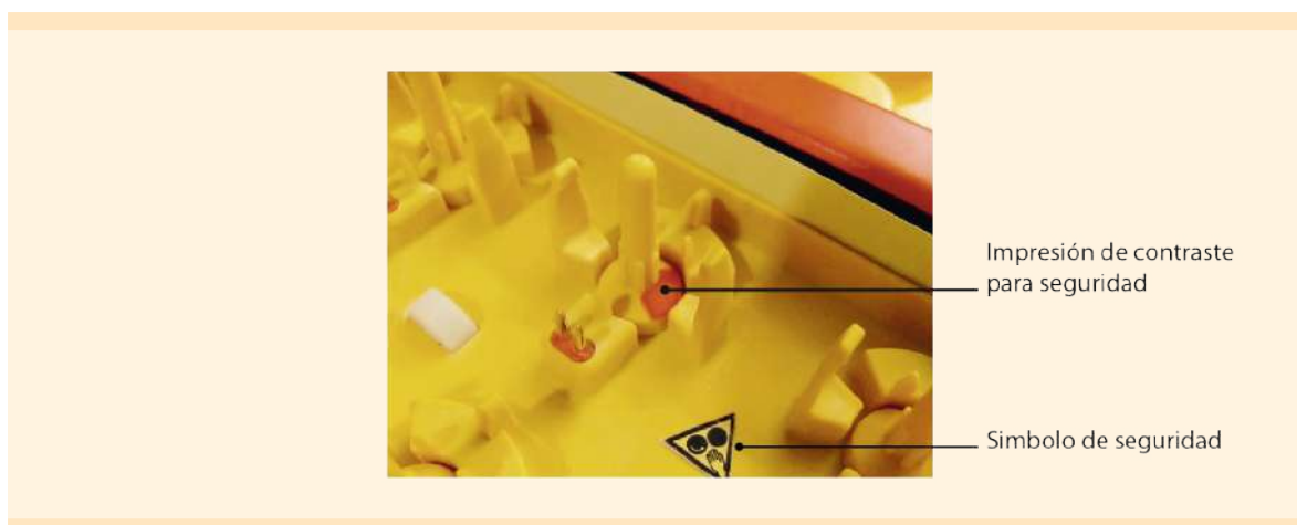
Figure 1: Símbolo de seguridad en la base del gentleMACS Octo Dissociator with Heaters. Los manguitos están marcados con una impresión de contraste para seguridad.
